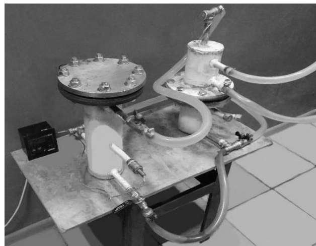
Рис. 1. Установка для экстракции древесной биомассы: 1 - экстракционная камера; 2 – холодильник; 3 - флорентинное устройство; 4 – сита; 5 – буферная емкость; 6 – нагреватель; 7 - кристаллизатор
